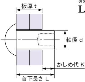
$L = \text{軸径}(d) \times \text{係数}(0.6) + \text{板厚}(t)$
